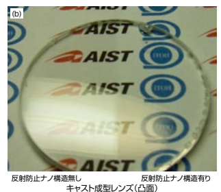
写真2 射出成形法により成型品を作製した例 (a) 平面金型の射出成形品 (b) レンズ金型の射出成形品
