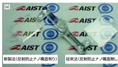
写真2 射出成形法により成型品を作製した例 (a) 平面金型の射出成形品 (b) レンズ金型の射出成形品
