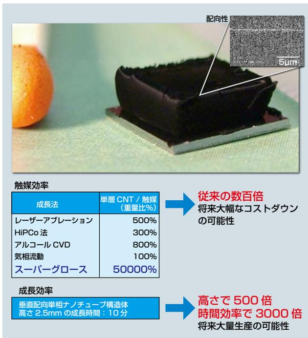
図1 スーパーグロース法によって合成した単層カーボンナノチューブ垂直配向構造体“フォレスト”
