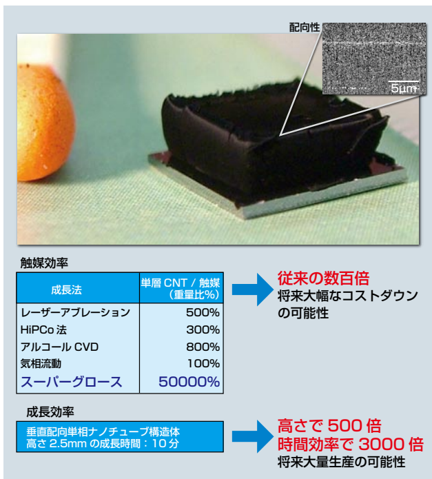
図1 スーパーグロース法によって合成した単層カーボンナノチューブ垂直配向構造体“フォレスト” 成長時間 10 分で、高さ数ミリの長さまで単層カーボンナノチューブを効率よく成長させることができます。
