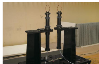
写真 電波暗室内で測定中のループアンテナ
