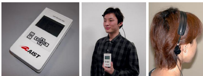
写真 骨導超音波補聴器
