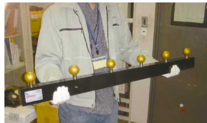
コンソーシアム活動で製作した寸法標準器
