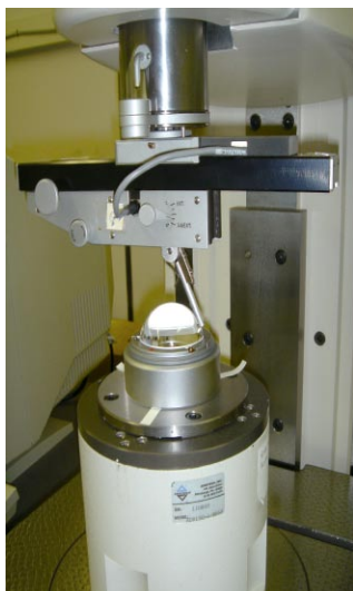
写真2 真円度校正装置
