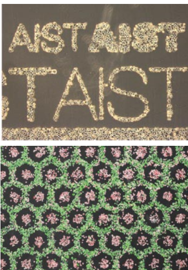
図1 オンデマンド二次元細胞操作技術による細胞のパターン培養(上)と精密共培養(下)
