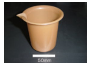
図2 セルロース-ポリエチレン系ポリマーアロイからの射出成形品
