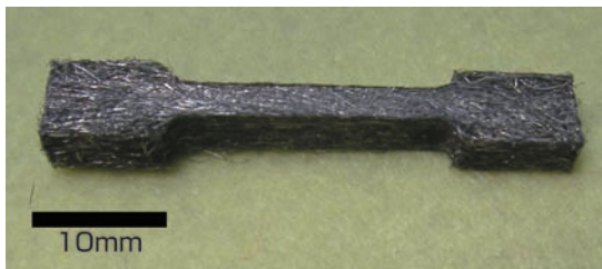
1. チタンの多孔質成形体(引張試験片形状の型を利用して成形)引張試験片を作製する型を用いてチタン繊維を多孔質成形体にした。
