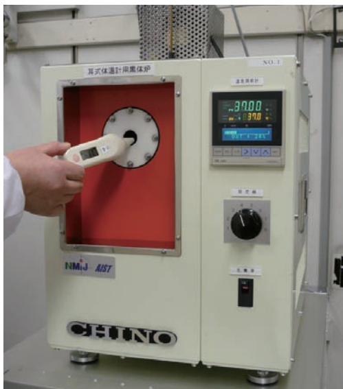
写真 標準黒体炉を用いた赤外線式体温計の校正の様子
