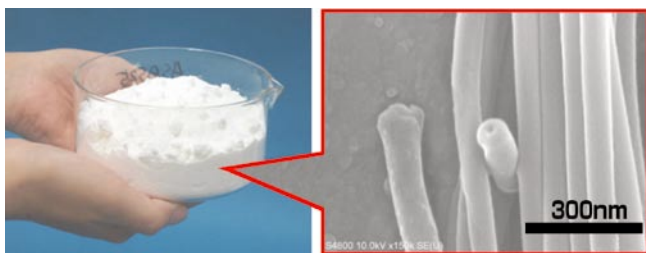
図1 (左) 有機ナノチューブ(平均外径 = 80nm、平均内径 = 60nm)で構成される白色固体粉末(重量は約100グラム)と(右)その走査電子顕微鏡写真
