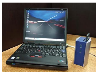
図6 ネットワーク起動機能を入れたルータ(右の青箱)とそれを使ってネットワーク起動したKNOPPIX
