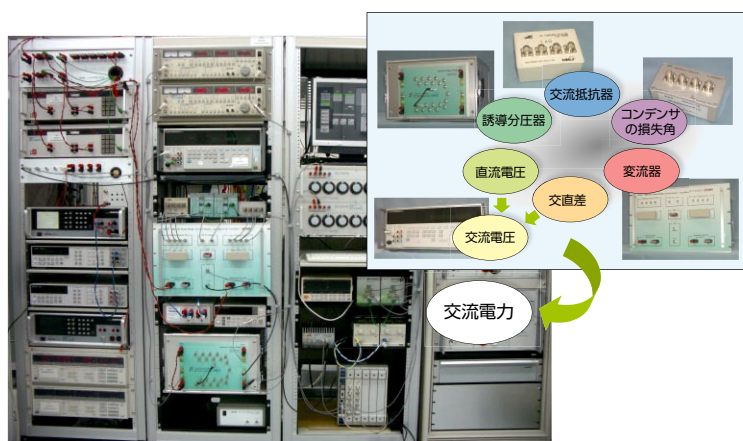
図1 開発された電力計校正システム
