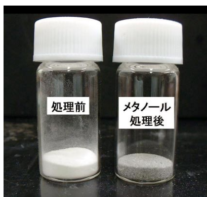
図1 鉛ガラス粉末(左)を280℃、10MPaの高温高压メタノールで6時間処理した後の状態(右)
