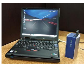
図6 ネットワーク起動機能を入れたルータ（右の青箱）とそれを使ってネットワーク起動したKNOPPIX
