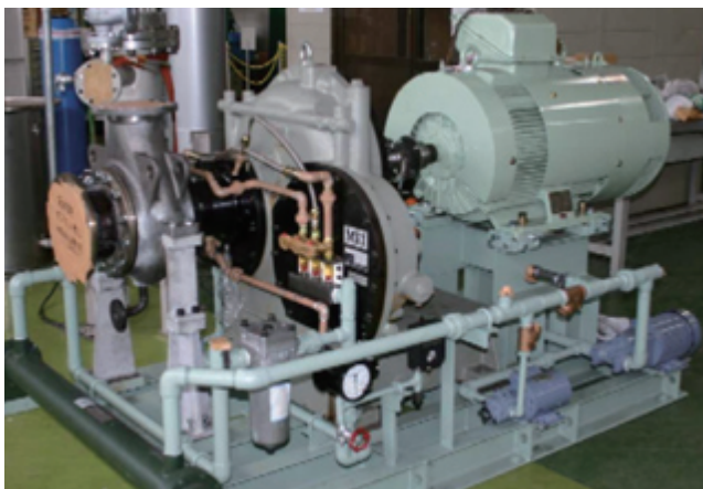
写真 小型貫流ボイラ発電システム 画像提供：(株)神戸製鋼所
