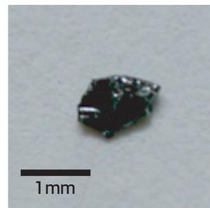
写真 高温高压下で育成したCoP<sub>3</sub>単結晶
