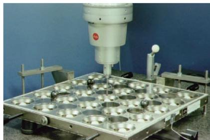
写真1 座標測定機上のボールプレート
