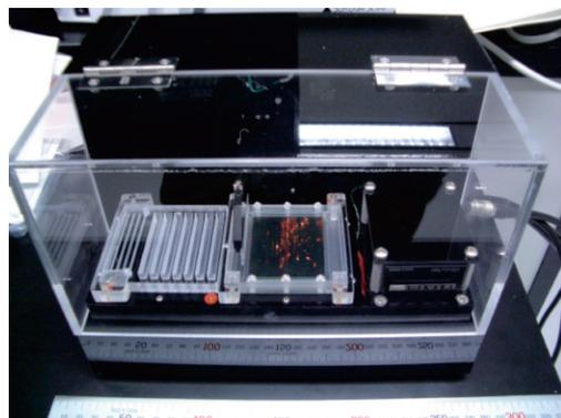
図2 全自動二次元電気泳動システム
