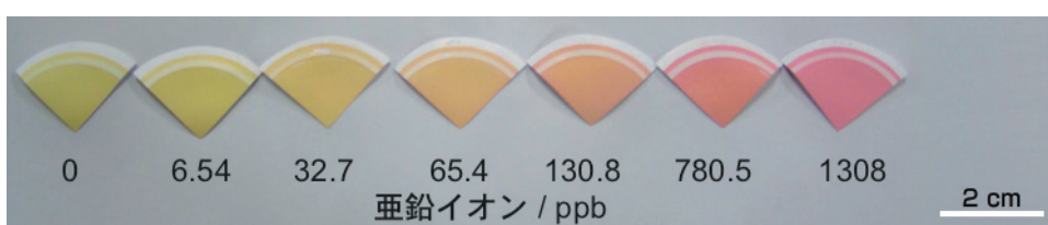
図3 有機試薬ピリジルアゾナフトールによるppbレベルの亜鉛イオンの検出
