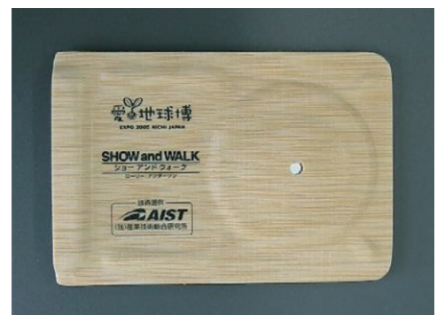
図2 愛・地球博のAimulet LAで採用された竹製の筐体
