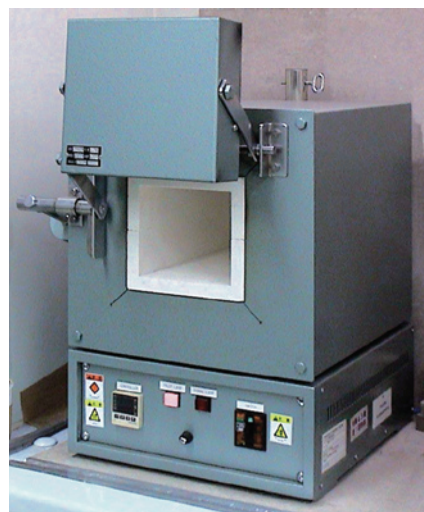
写真2 乾式灰化用の電気炉 値付けのための試料分解方法の一つとして採用した乾式灰化に用いた電気炉で、石英ビーカー中の ABS 樹脂試料を 350 °C で分解した。
