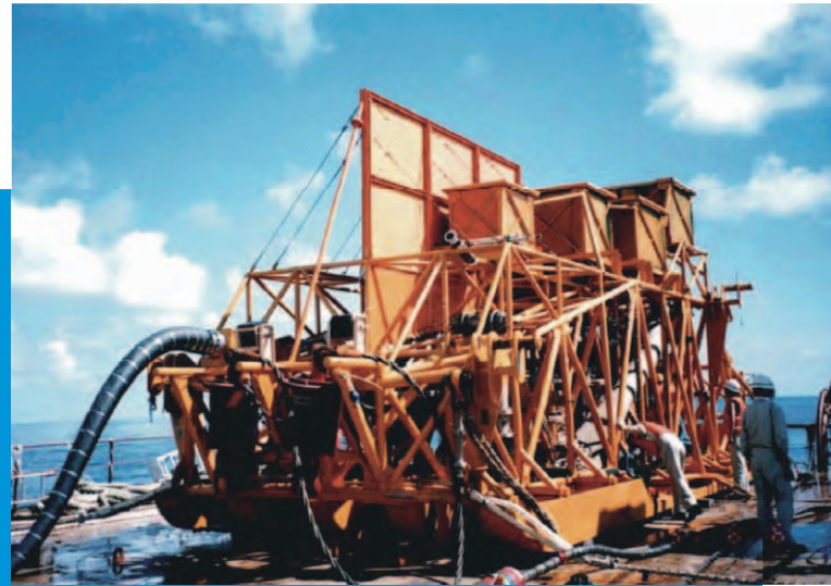
写真 大型プロジェクト「マンガン団塊採鉱システムの研究開発」の海洋実験用集鉱機 長さ：13.2m、幅：4.6m、高さ：5m、空中重量：26.8t、水中重量：12.4t
