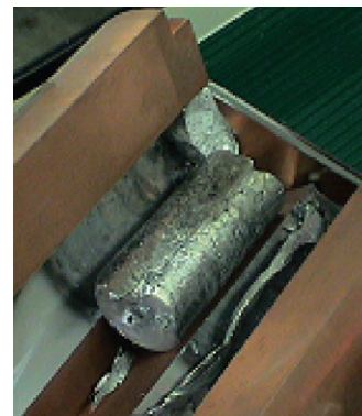
写真3 新溶製法によって溶製した5%級高容量カルシウム系ラーベス相水素貯蔵合金
