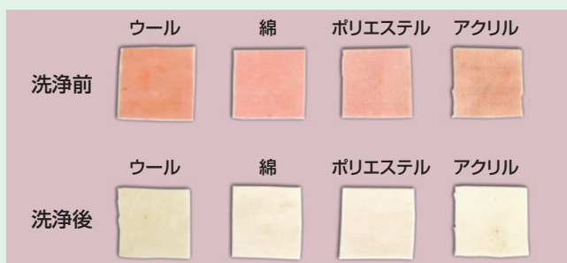
写真2 超臨界CO 2 による洗浄での布の違いによる洗浄結果 汚れ成分：流動パラフィン+オイルレット(染料) 洗浄条件：二連吐出
