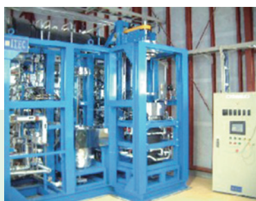
写真1 超臨界CO 2 クリーニング装置
