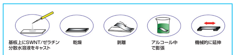
図1 ナノチューブをゼラチンの中に分散して配向膜を作る手順
