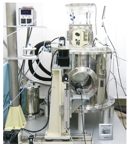
図3 圧力浮遊装置 固体試料が入った圧力浮遊セルを真空断熱恒温槽から取り出した状態
