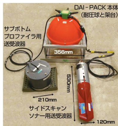
図1 深海底精密地質構造探査装置(DAI-PACK)の構成
