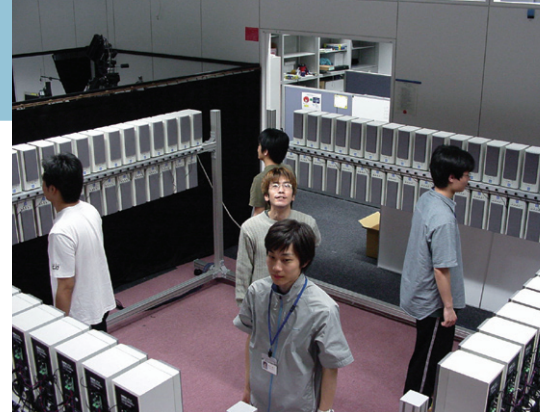
写真 128ch マイクアレイで、5人の人に別々の音を聞かせることができる
