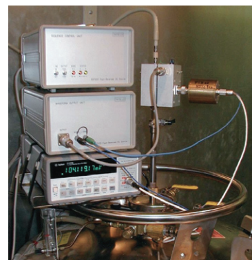
写真2 プログラマブル型ジョセフソン電圧標準素子を用いて行われる、高精度のファスト・リバースDC測定。
