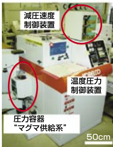
図2 減圧実験の実験装置(左) 1) と実験産物の気泡のサイズ分布(右) 2)
