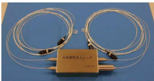
写真1 光制御式光スイッチ試作機 (外観)
