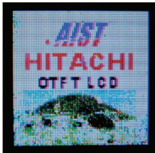
図1 有機TFT駆動カラー液晶表示パネル
