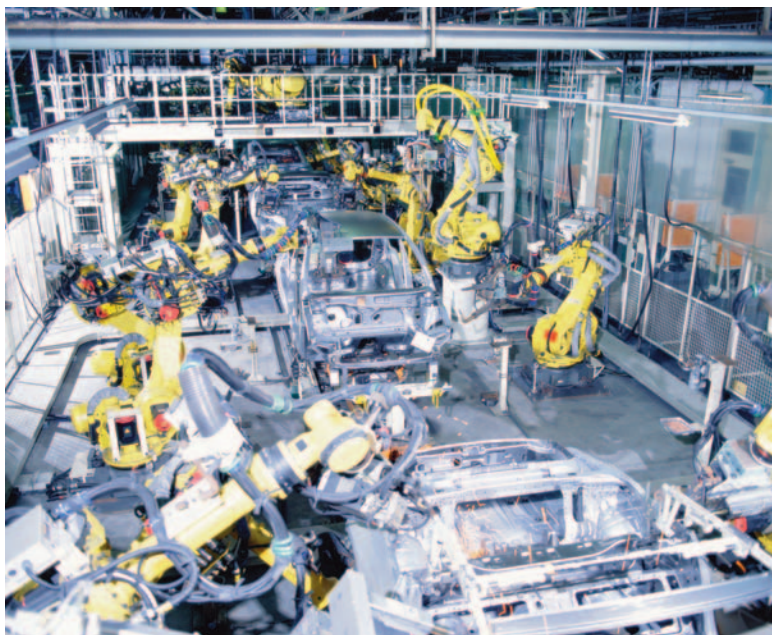
写真1 生産ラインの溶接行程 たくさんのロボットによる正確な作業が進められる。(写真提供:日産自動車)
