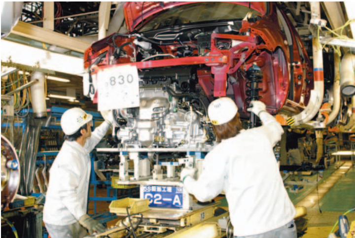
写真2 エンジンユニットの搭載行程 人の技術と計量標準が安心と安全の確保に役立てられている。 (写真提供：日産自動車)
