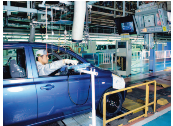
写真3 生産ラインをでた製品の完成検査 各種の計測器が使用される。(写真提供：日産自動車)
