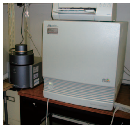
写真 各種定量的PCR装置 左の黒い装置はRoche社のライトサイクラー (LightCycler)、右の四角い大きな装置はApplied Biosystems社のプリズム 7900HT (PRISM-7900 HT)。
