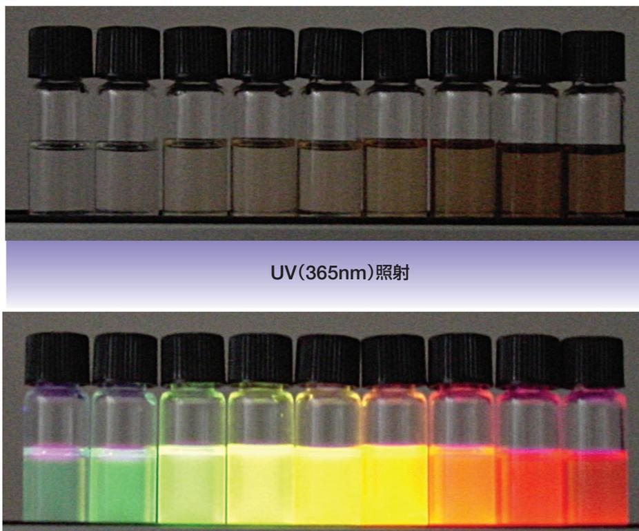
加熱時間を300℃とし、2秒—140秒の加熱でCdSeナノ粒子を合成した。加熱時間が短いものは、粒子径が小さく(～2nm)青緑色の蛍光を、加熱時間が長いものは粒子径が大き(～5nm)赤色の蛍光を発した。
