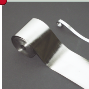
液体急冷法で作製した アモルファス合金膜 本誌 リサーチ ホットライン 9ページ
