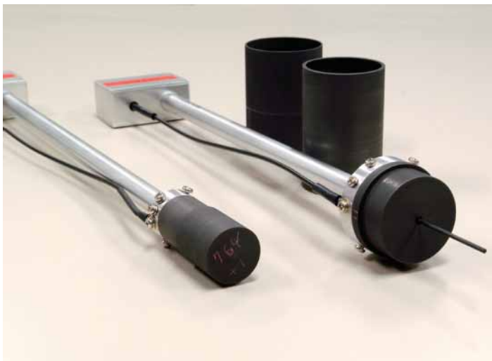
図1 円筒型グラファイト空洞電離箱
