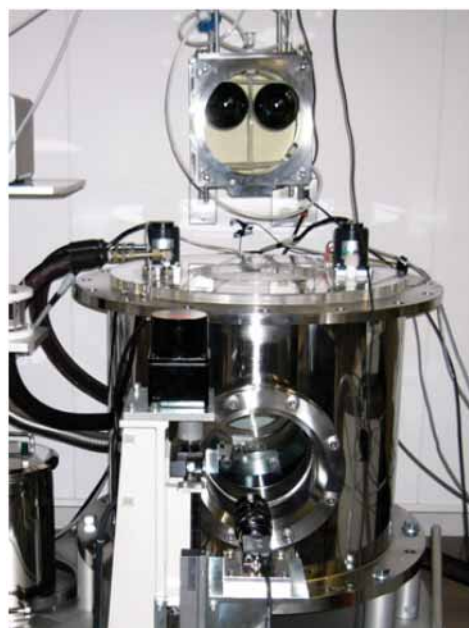
写真2 圧力浮遊法による固体密度の超精密比較装置
