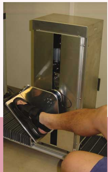
図2 低負荷下肢神経筋機能訓練装置試作機 足関節、膝関節、股関節の屈曲伸展に関係した筋の機能を個別あるいは複合的に訓練できる。
