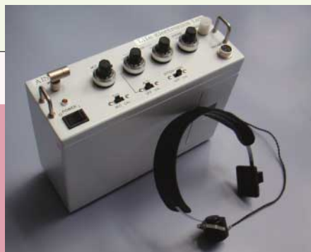
骨導超音波補聴器
