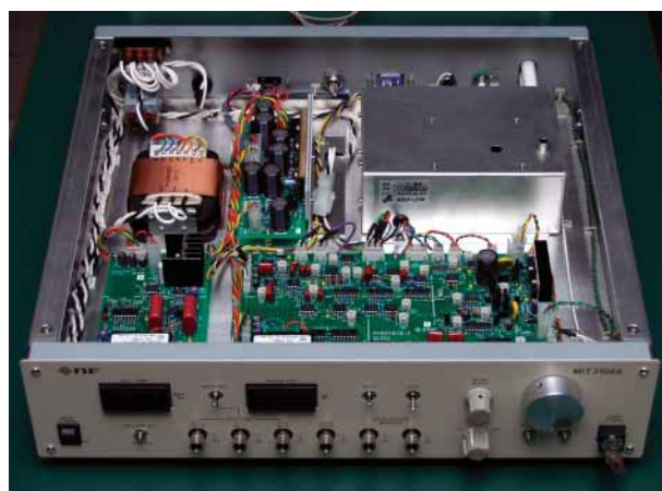
写真2 回路の理解、調整に配慮した制御装置
