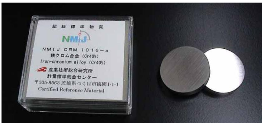
図 蛍光X線分析用鉄クロム合金(Cr40%)標準物質の写真
