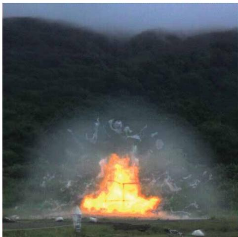
●写真2 高速度カメラにより撮影した化学量論組成のDME/空気混合ガスの爆発火炎
