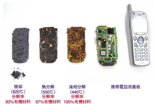
図1 携帯電話用基板の化学リサイクル
