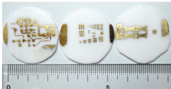
図2 テフロン表面への化学めっき (ニッケルめっき+金置換めっき処理)
