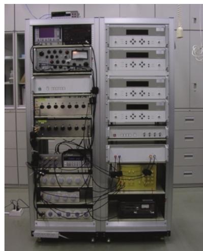
写真2 誘導分圧器の分圧比校正システム
