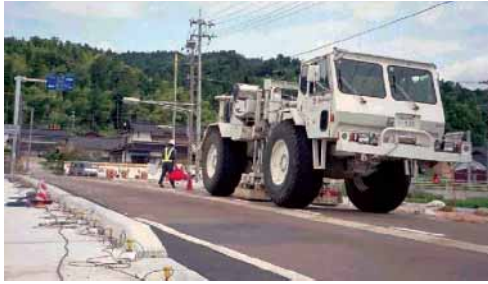
●写真 反射法地震探査の様子 右側の起振車で地面に振動を与えて、左側の地震計の列で地中から反射した波を受振し、それらを解析することにより、地下の反射断面が得られる。
