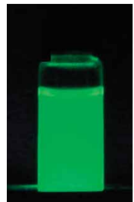
図3 水に分散させたZnS-CdSeナノ複合粒子からの蛍光
