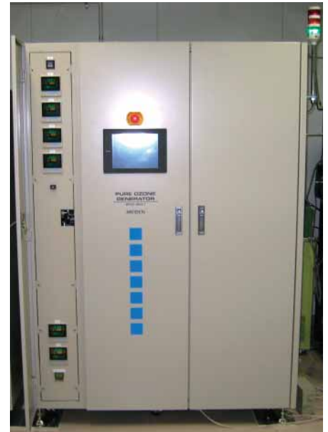
写真 超高濃度オゾン連続発生装置 Continuous 100% ozon generator
