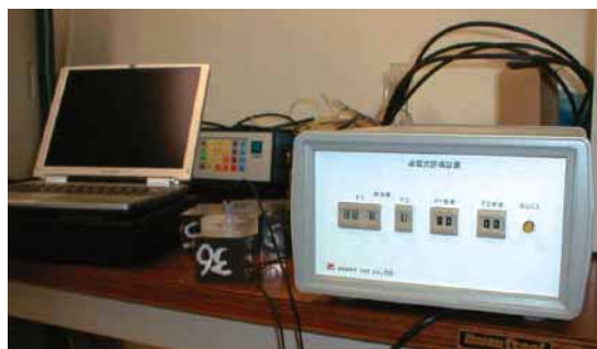
写真 鋳鉄評価用の渦電流装置、本体(右)、コイルと試験片(中央)、結果を表示するパソコン(左)
