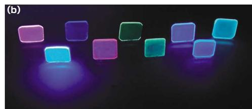
図2 (a) 可視光で見た蛍光ガラス (b) 紫外線(254nm)照射下で光る蛍光ガラス
