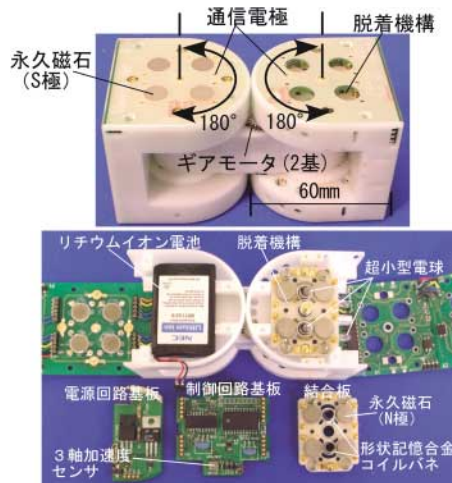
図1 M-TRAN IIモジュール(上)と内部構造(下)
