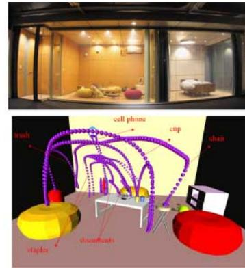
図 人を見守るセンサールーム：カップや本に取り付けられた発信器からの信号を壁に埋め込まれたセンサーが追跡することで人の行動を解釈する。
