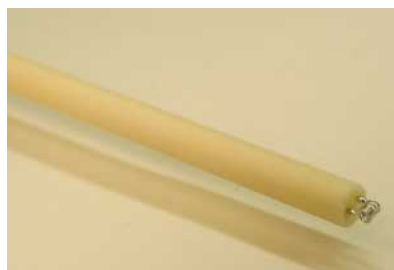
●写真2 白金パラジウム熱電対 (コイルつき) 純白金素線と純パラジウム素線を用いた熱電対。高温における両素線の熱膨張の差が、発生する起電力に対して影響を及ぼさないように、先端をコイル状に加工している。
