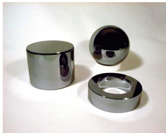
●写真 密度の特定二次標準器（シリコン単結晶） 左：1 kg円柱、右上：1 kg球体、右下：200 gリング。
