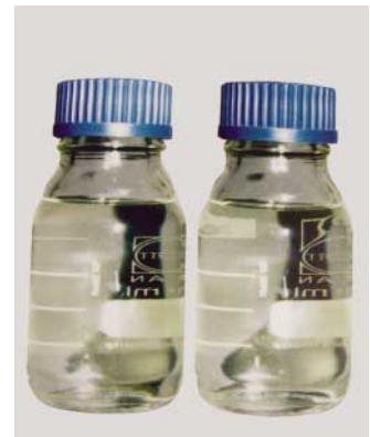
●写真3 写真2の熱処理物を触媒と共にさらに熱分解して得られたガソリンおよびナフサ留分であり、90%近い油化率を達成。
