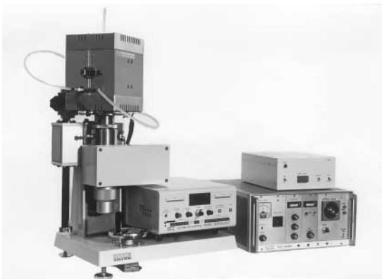
●写真1 本標準化研究のために開発した熱量天秤プラスチックの熱量変化と重量変化を同時に測定可能なものであり、測定された各種プラスチックの比熱、融解熱、分解・気化熱等を使用して、混合プラスチックの脱塩素プロセス、プラスチックの油化プロセスが設計された。
