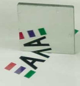
鏡状態の調光ミラー薄膜 (表紙は透明状態)
