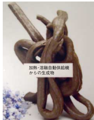
●写真2 塩化ビニルを20重量%含むプラスチック廃棄物を脱塩素化・減容化した熱処理物脱塩素率は99.99%でこのままボイラー燃料として使用可能。
