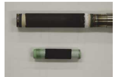
●写真 プラズマ溶射法(上)および湿式共焼結法により(下)で作製された小型円筒型セル
