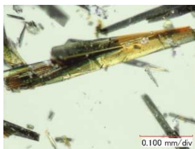
図（上） フッ素系ハイブリッド化合物における5つのタイプの結晶構造 写真（左） フッ素系ハイブリッド化合物の光固相重合によるポリマー結晶
