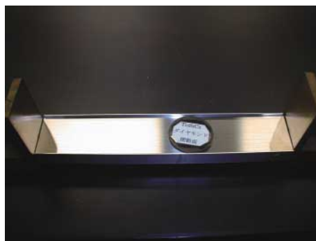
写真1 ステンスレール上の鏡面ダイヤモンド摺動面 滑らせると両端で反射してゆっくりと1~2往復する。
