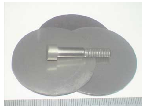
写真2 チタンシリコン炭化物のダイヤモンド成膜用基板 ネジは旋盤で加工したもの。
