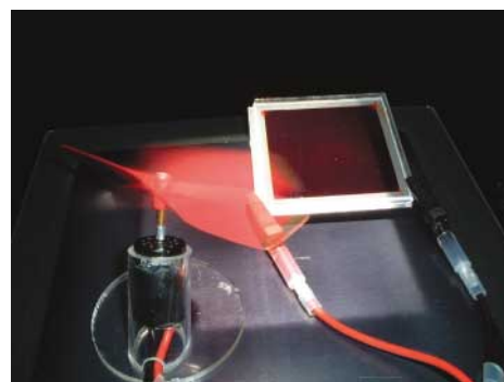
写真 新規クマリン色素増感太陽電池 クマリン色素増感太陽電池によるプロペラの動作風景
