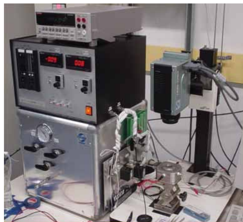
写真2 触媒活性と熱電変換性能を別々に評価するために開発された熱電式水素センサの特性評価装置
