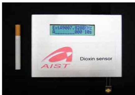
写真 水晶振動子式ダイオキシンセンサー
