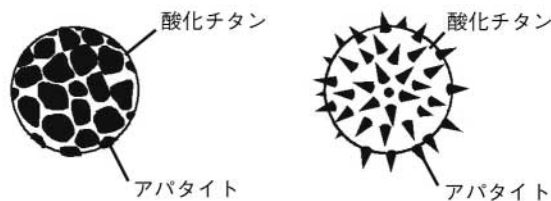
図1 酸化チタンの表面にアパタイトを付けた繊維やプラスチックに使用可能な光触媒
