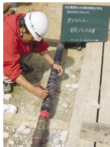
図2 応力測定用型取りバッカーによる孔壁亀裂の記録
