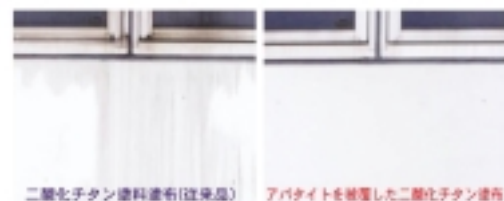
写真 アルミパネルへの塗布による防汚効果の比較 (屋外80日暴露)
