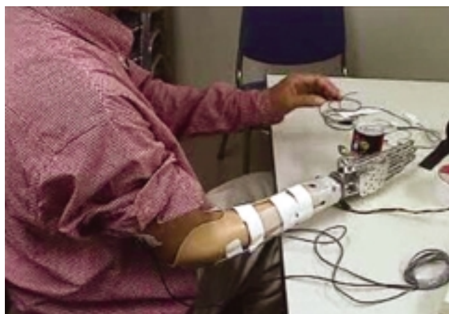
写真2 多指・多機能ロボットハンドの臨床評価
