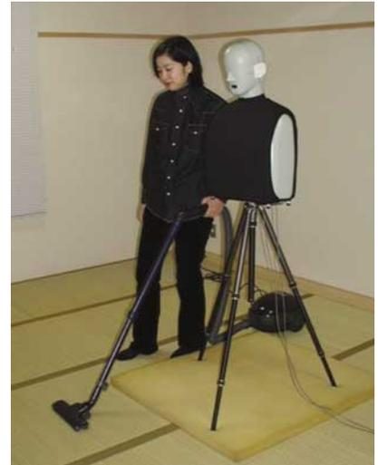
ダミーヘッドを用いた掃除機の動作音の収録
