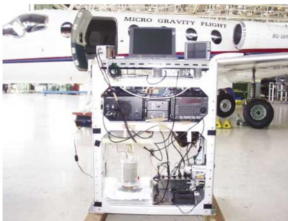
写真 無重力環境での液(水)量計測実験装置
