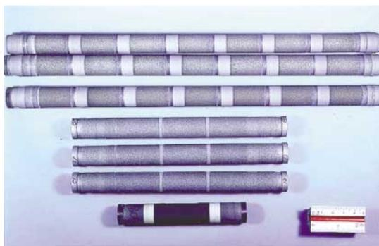
試作した固体酸化燃料電池スタック
